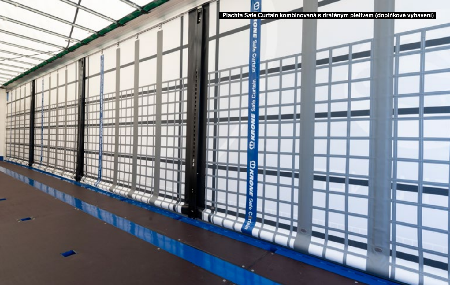
Patentované napojení pruhů pružinové oceli (Safe Curtain)
